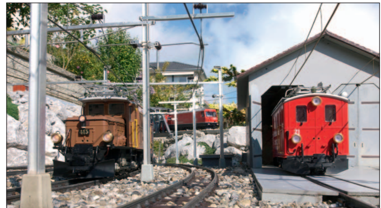
Güterzug im unteren Bahnhof, im Hintergrund das nachgebaute Bahnhofsgebäude von Worb Dorf im Ursprungszustand. Hier ist gut ersichtlich, wie die Hänger an der Fahrleitung angehängt sind.
