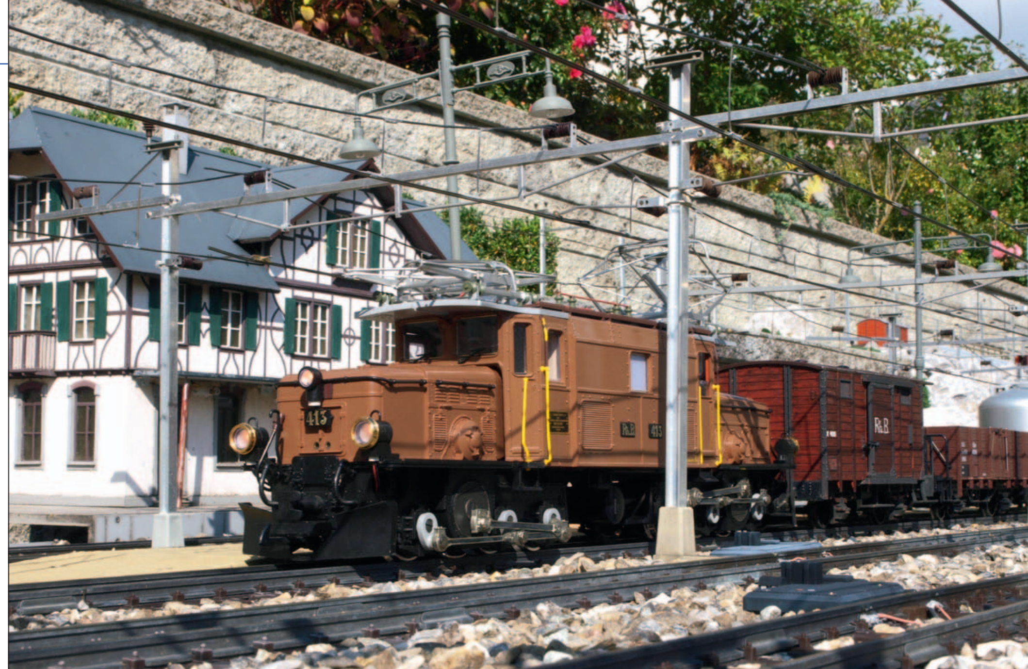
Güterzug im unteren Bahnhof, im Hintergrund das nachgebaute Bahnhofsgebäude von Worb Dorf im Ursprungszustand. Hier ist gut ersichtlich, wie die Hänger an der Fahrleitung angehängt sind.
